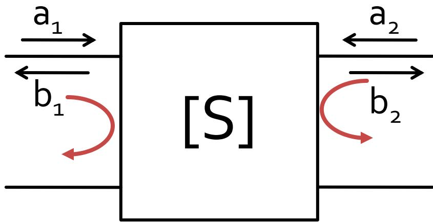
$$\begin{bmatrix} b_1 \\ b_2 \end{bmatrix} = \begin{bmatrix} S_{11} & S_{12} \\ S_{21} & S_{22} \end{bmatrix} \cdot \begin{bmatrix} a_1 \\ a_2 \end{bmatrix}$$
