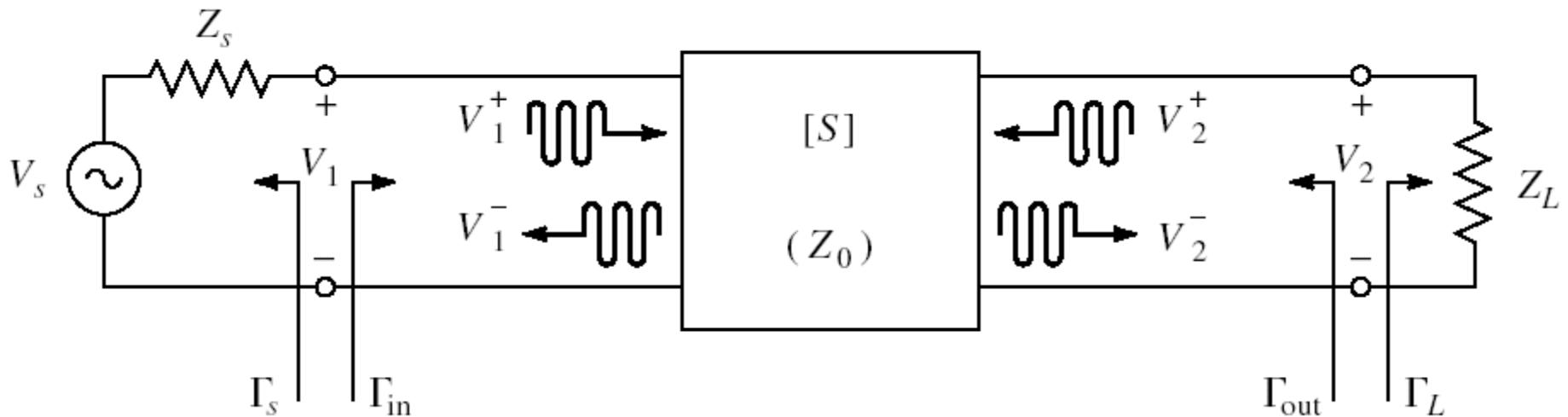
$$\Gamma_L = \frac{Z_L - Z_0}{Z_L + Z_0} \quad \Gamma_S = \frac{Z_S - Z_0}{Z_S + Z_0} \quad \begin{bmatrix} V_1^- \\ V_2^- \end{bmatrix} = \begin{bmatrix} S_{11} & S_{12} \\ S_{21} & S_{22} \end{bmatrix} \cdot \begin{bmatrix} V_1^+ \\ V_2^+ \end{bmatrix}$$
